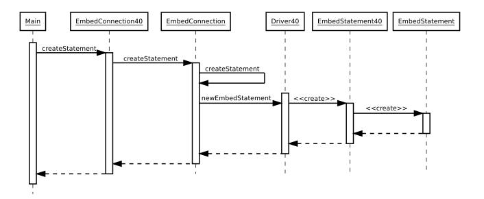
Abbildung 2.4: UML-Sequenzdiagramm: Statement erstellen
