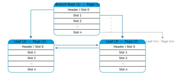
Abbildung 4.2: B<sup>+</sup>-Baum Grundaufbau
