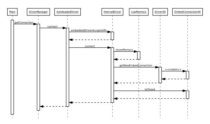
Abbildung 2.3: UML-Sequenzdiagramm: Verbindung erstellen
